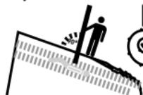
Suchen Sie den/die Verschüttete(n) in dem Sie sich Schritt für Schritt vom letzten vom Ihrem LVS-Gerät aufgezeigten Punkt entfernen. Sondieren Sie senkrecht zur Neigung.
