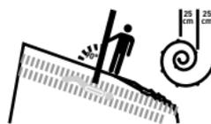
ARVAによって特定された最小距離地点から同心スパイラル状にプロービングを行い、埋没者を検索します。プローブは斜面に対して垂直に差し込んでください。
