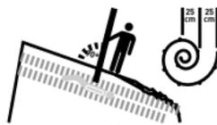
Sök efter den saknade genom att sondera i koncentriska spiraler successivt bort från minsta avståndspunkten angiven av din ARVA. Sonda vinkelrätt (90°) mot lutningen.
