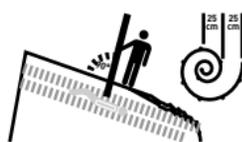
Etsi uhria sondilla piipparisi havaitsemasta pienimmästä etäisyyslukemasta asteittain pois päin kiertäen sondaamalla. Sonda kohtisuorassa rinteeseen.
