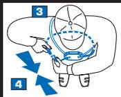
Den *patroller* nach der Tour abnehmen. Durch Öffnen des Bajonettverschlusses (8) wird das Gerät ausgeschaltet. Wickeln Sie den Trageriemen um das Gerät und befestigen Sie ihn mit dem Druckknopf.
